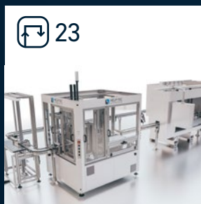
Be-/Entladen Shuttle Chargement/déchargement de navettes
